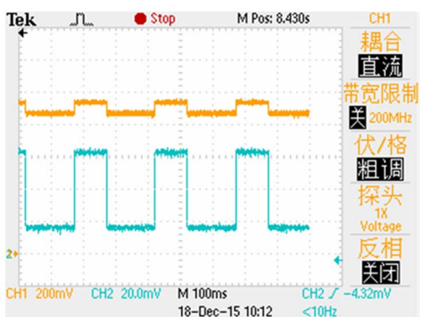
(b) 外触发控制电流测试结果
